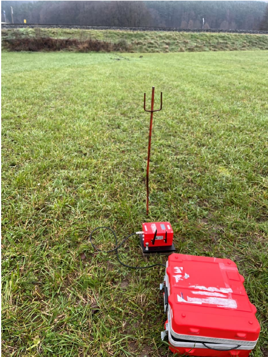
Abbildung 1: Installation des Schwingungsmesssystems MR121 auf einem Erdspieß am MP1 während des Messtermins vom 04.12.2024 (Entfernung vom Gleis: ca. 30 m)
